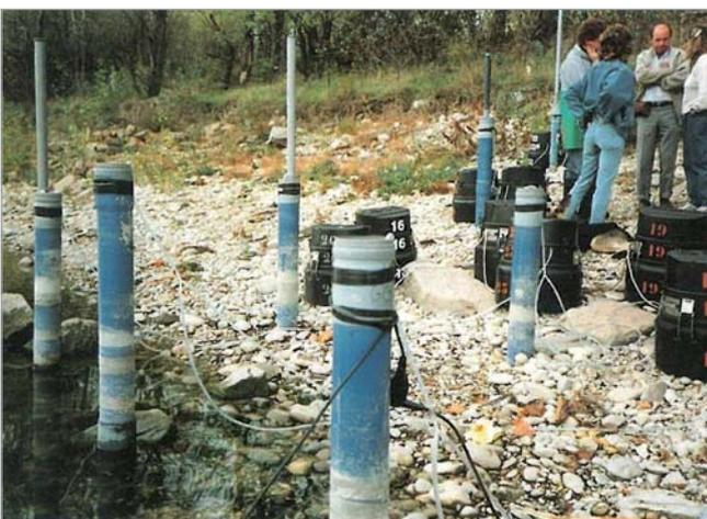
Dispositif expérimental de mesure de l'effet filtre des berges sur la rive du Rhône à l'île du Grand Gravier (Grigny - 69). BRGM, 1991
