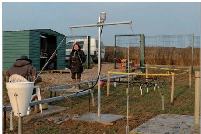
Bassin de l'Hallue : Site expérimental de mesures de dépression dans l'aquifère de la craie non saturé, par mesures tensiométriques (Warloy-Baillon - Somme, 2006). L. Bertrand
