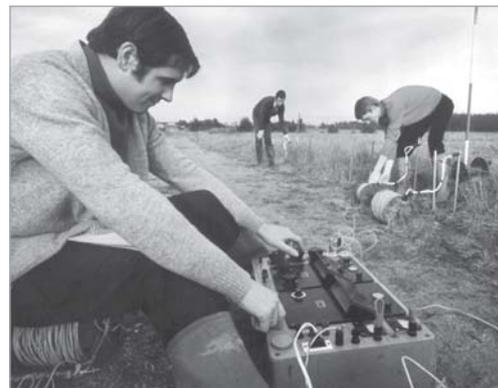
Recherche des zones aquifères fissurées par prospection géophysique électrique. BRGM
