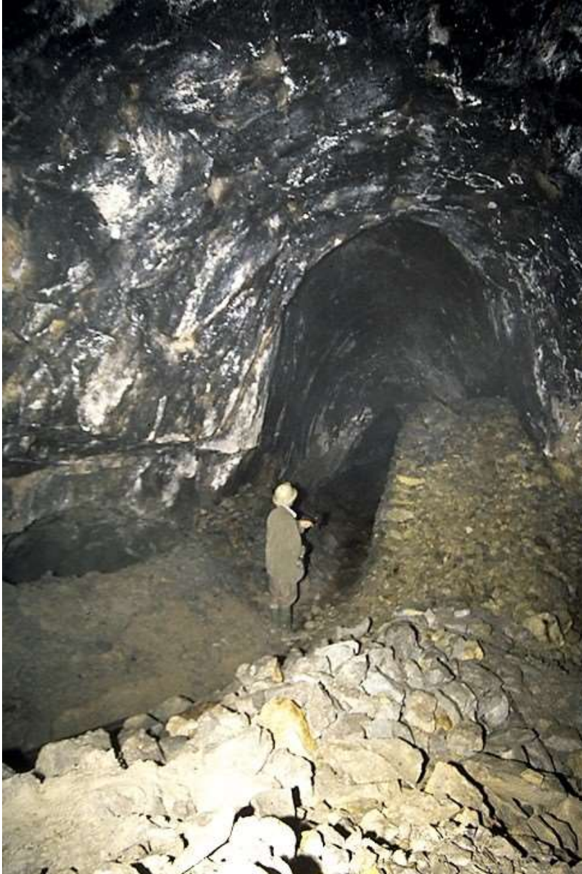
6 Vallauria : superbe voûte creusée avec le feu et remblais modernes ; Jean Davoux donne l'échelle (photo Féraud)
